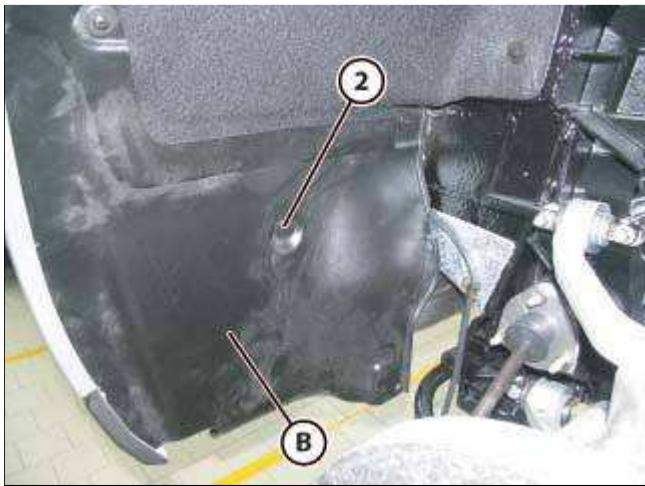
■ 拆卸轮拱罩后部 (B), 松开四个螺钉 (2)。
