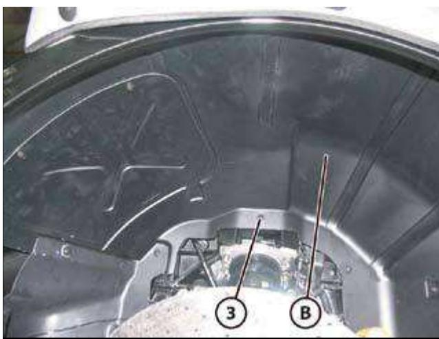
● 拆卸轮拱罩中部 (B), 松开五个螺钉 (3)。
