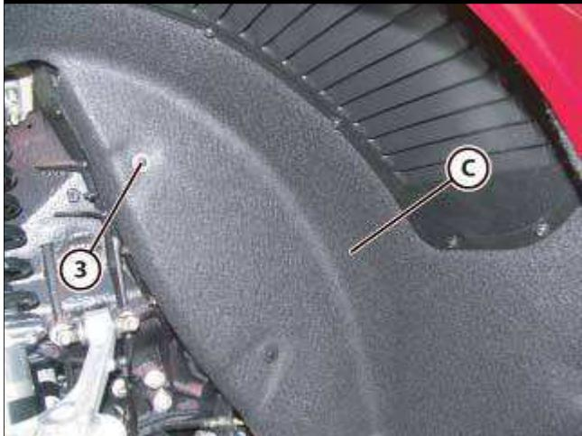
■ 拆卸轮拱罩前部 (C), 松开七个螺钉 (3)。
