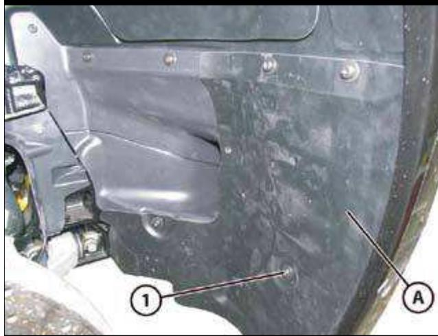
● 拆卸轮拱罩前部 (A), 松开七个螺钉 (1)。
