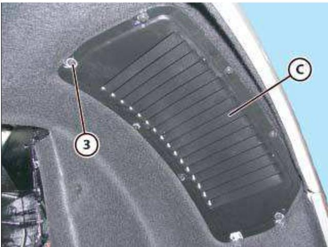
● 将格栅 (C) 置于前部并用八个螺钉 (3) 紧固。
