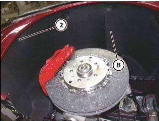
● 拆卸轮拱罩前部 (B), 松开八个螺钉 (2)。
