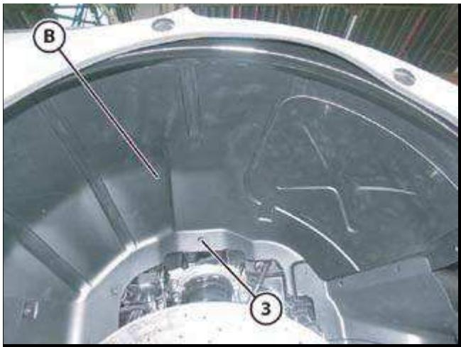
● 拆卸轮拱罩中部 (B), 松开六个螺钉 (3)。
