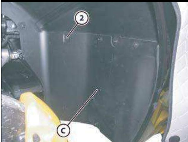
● 拆卸轮拱罩后部 (C), 松开七个螺钉 (2)。
